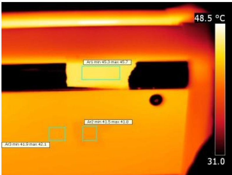
De alu strip aan de kant van de buis aan een zijkant van de lamp. Tevens de temperatuur aan de zijkanten van de lamp. De emissiviteit van de behuizing van de lamp zelf is vergelijkbaar met die van de schilderstape.
